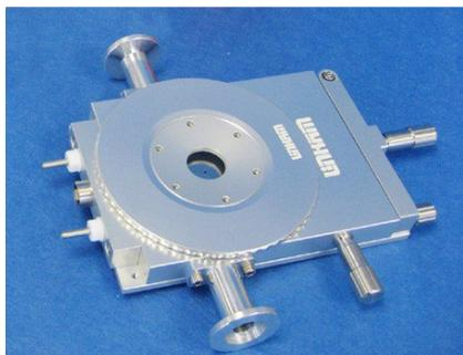
*Linkam THMS350V – столик для охлаждения образца до 77 К для применения в микроскопии*
