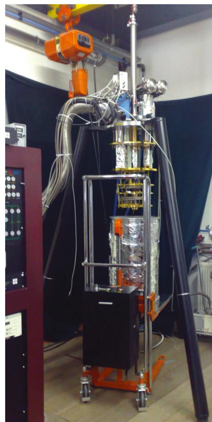
*Криостат растворения замкнутого цикла производства Leiden Cryogenics BV, установленный на стойке*
